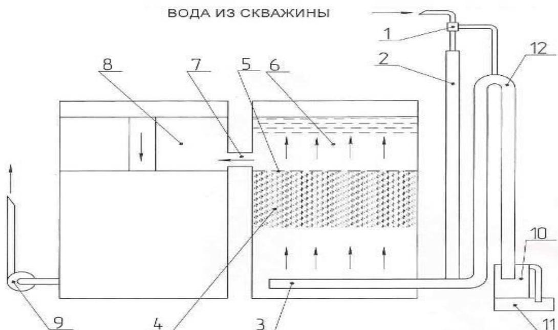
1. Аэратор-дегазатор; 2. Гидроробот; 3. Распределитель; 4. Фильтрующая плавающая загрузка; 5. Кольцо; 6. Надфильтровая емкость; Патрубок; 8. Емкость для чистой воды (изготавливается по требованию Заказчика); 9. Насос II-го подъема (не входит в состав фильтра-модуля); 10. Гидрозатвор; 11. Емкость для промывной воды (изготавливается по требованию Заказчика); 12. Сифон
